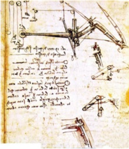
Görsel 1: Leonardo Da Vinci Çizimi: Kanadı hareket ettirecek düzenek tasarımı, Torino, İtalya
